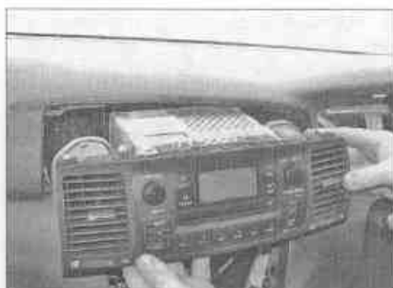
Рис. 17.2,в. ...и извлеките блок из лицевой панели
