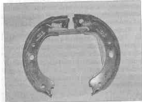
Рис. 10.5,з. Проверьте положение верхних пружин и распорной планки перед снятием
