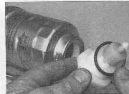
Рис. 17.9. Установите новое уплотнительное кольцо на датчик-переключатель уровня
