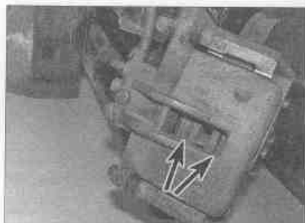
Рис. 11.2. Проверьте толщину тормозных колодок
