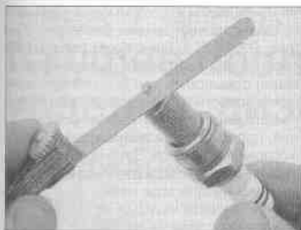
Рис. 22.4. Измерьте щупом межэлектродный зазор в свече зажигания
