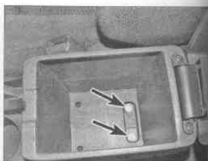
Рис. 28.1. Откройте крышку вещевого отсека и выверните два винта (отмечены стрелками)
