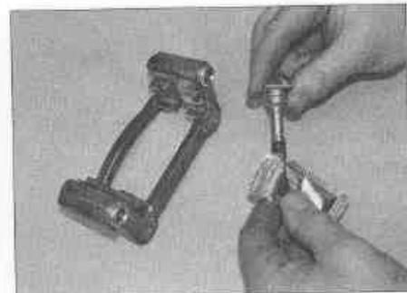
Рис. 8.16,б. Нанесите смазку на направляющий палец и чехол...
