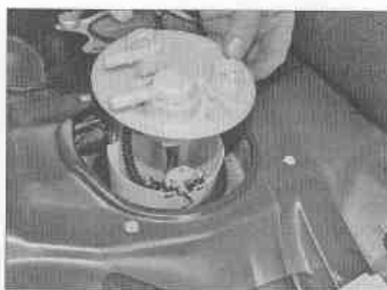
Рис. 3.25. Снятие топливного насоса/датчика указателя уровня топлива
