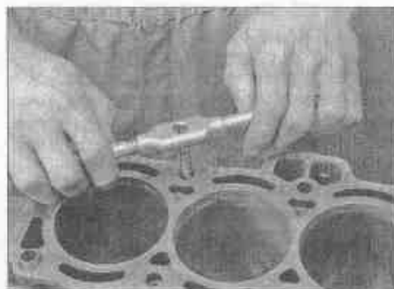
Рис. 13.8. Очистите и «прогоните» метчиком все отверстия под болты в блоке цилиндров
