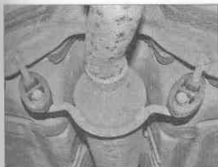
Рис. 12.2,а. Проверьте состояние резиновых опор системы выпуска
