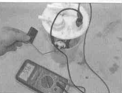
Рис. 4.4. Подведите щупы омметра к клеммам датчика
