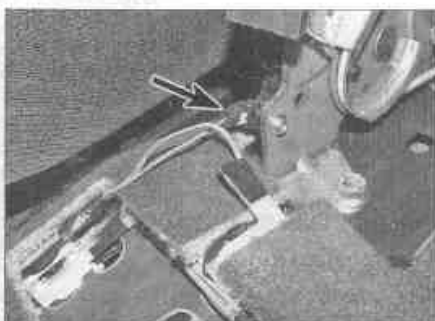
Рис. 16.3. Рассоедините электрический разъем выключателя контрольной лампы (отмечен стрелкой)
