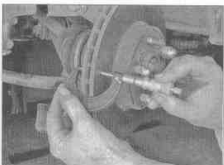
Рис. 6.3. Используя микрометр, измерьте толщину диска
