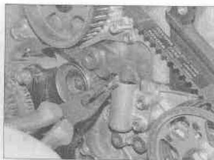
Рис. 7.32. Извлеките шплинт, чтобы активировать натяжитель
