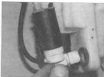
Рис. 13.9. Вытяните насос из уплотнительной втулки в бачке омывателя
