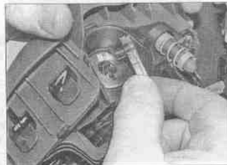
Рис. 20.4,б. ...и рассоедините электрический разъем подушки безопасности
