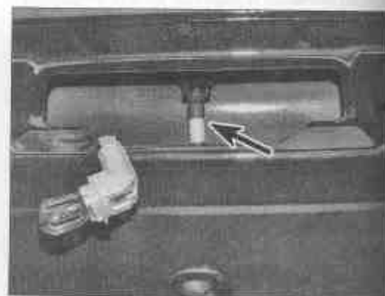
Рис. 13.17.а. Отсоедините шланг омывателя (отмечен стрелкой)...
