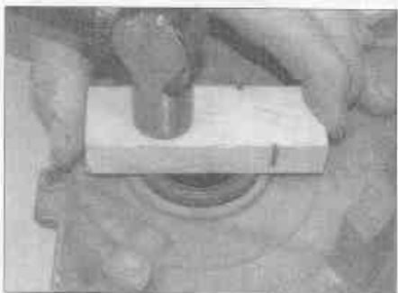
Рис. 7.1.а. Используя деревянный брусок и молоток, забейте новую манжету в посадочное отверстие
