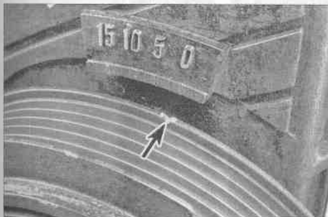
Рис. 3.6. Совместите метку на шкиве коленчатого вала (отмечена стрелкой) с цифрой 0 на крышке газораспределительного механизма
