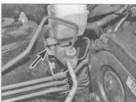
Рис. 11.6,а. Выверните винт, чтобы снять бачок
