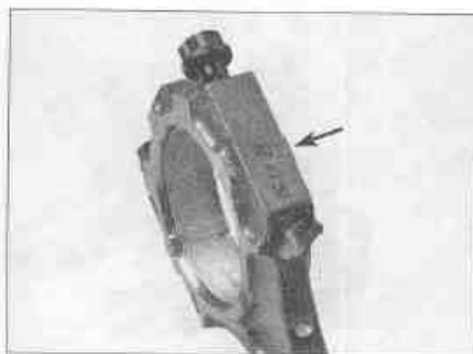
Рис. 11.3. Не перепутайте эту маркировку с номером шатуна: это — идентификационная маркировка размера подшипника
