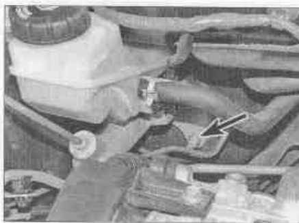
Рис. 11.5. Отверните гайки главного тормозного цилиндра (показана одна)
