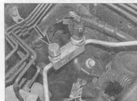
Рис. 12.12.а. Сервисный порт высокого давления (отмечен стрелкой) (модель с дизельным двигателем)
