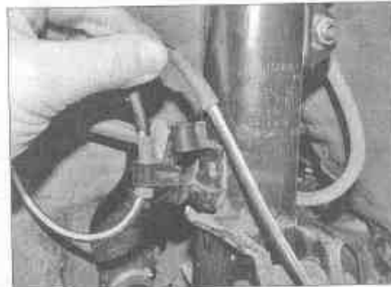
Рис. 21.12. Высвободите электропроводку из зажима на стойке
