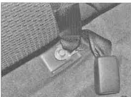
Рис. 26.19. Нижний элемент крепления центрального ремня безопасности
