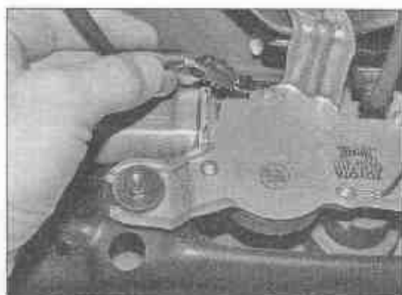
Рис. 16.4. Рассоедините электрический разъем
