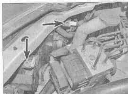
Рис. 10.2. Винты регулировки света фар (отмечены стрелками)
