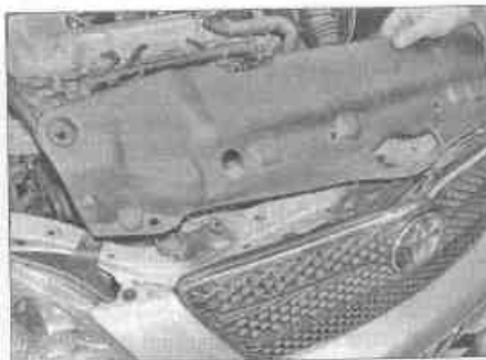
Рис. 6.4,б. ...и снимите переднюю панель отделки
