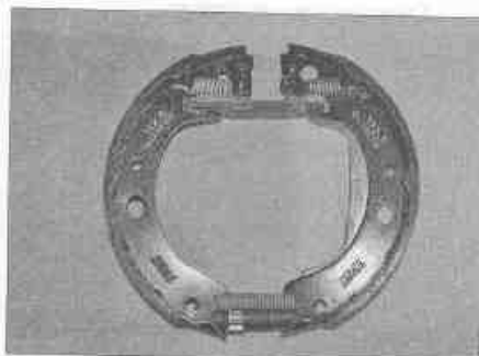
Рис. 10.4. Расположение колодок стояночного тормоза
