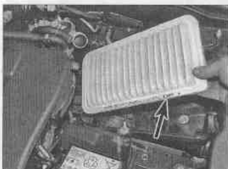
Рис. 6.4. Отметьте положение установки фильтрующего элемента
