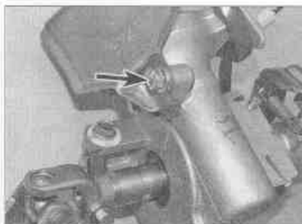
Рис. 19.8. Выверните болт крепления экрана (отмечен стрелкой)
