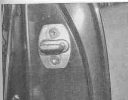
Рис. 12.7. Отпустите винты и сдвиньте ответную часть замка в требуемое положение
