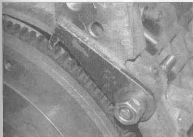
Рис. 13.4. Застопорите маховик с помощью инструмента, закрепленного на блоке цилиндров
