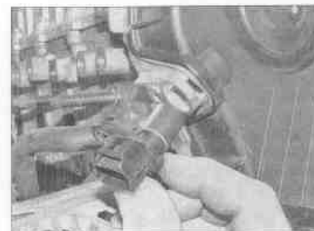
Рис. 10.4. Снятие датчика положения распределительного вала
