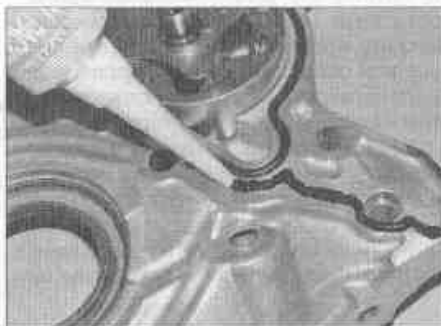
Рис. 13.13,б. Отрежьте кончик тубы с герметиком, чтобы получить ширину валика 2–4 мм
