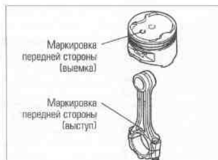
Рис. 21.9. Убедитесь в том, что метки на поршне и шатуне совмещены
