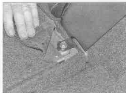
Рис. 24.11,б. ...и оттяните ковровое покрытие для доступа к болту
