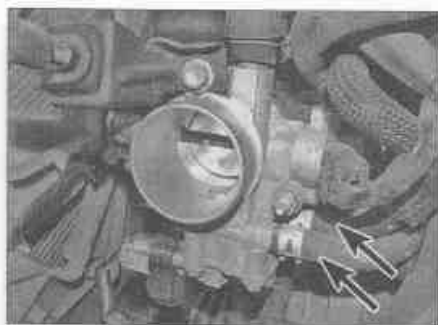
Рис. 12.7. Отсоедините шланги охлаждающей жидкости (отмечены стрелками)
