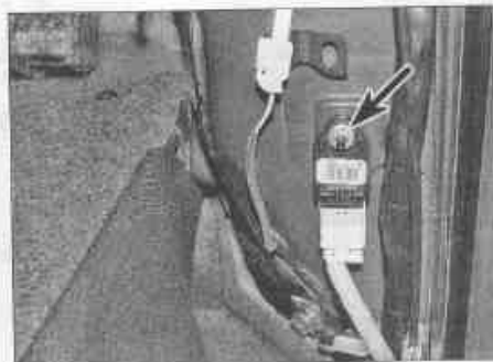
Рис. 20.34. Гайка крепления датчика удара (отмечена стрелкой)
