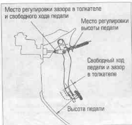
Рис. 14.5.а. Регулировки зазора в толкателе педали сцепления, высоты педали и свободного хода педали выполняются путем отпущения контргайки и вращения резьбового регулятора
