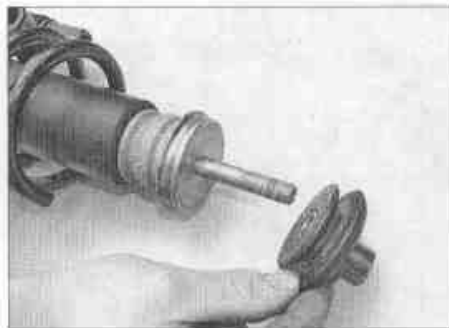
Рис. 3.12,а. Снимите верхнюю резиновую втулку...
