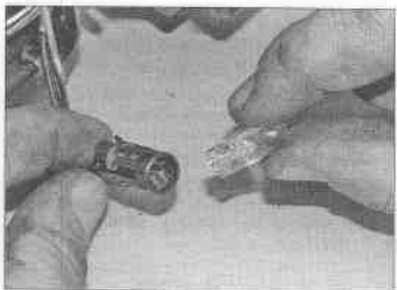
Рис. 7.12. Установка лампы клинового типа
