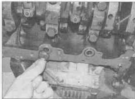
Рис. 13.17,а. Установите два новых уплотнительных кольца в предусмотренные канавки...
