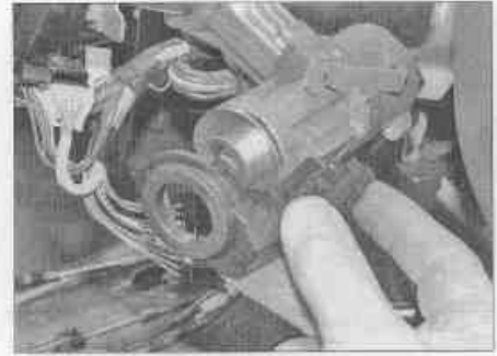
Рис. 4.8,б. ...и высвободите транспондер из переключателя
