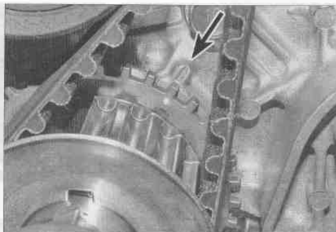
Рис. 3.6.б. Метки ВМТ на зубчатом шкиве коленчатого вала и корпусе масляного насоса
