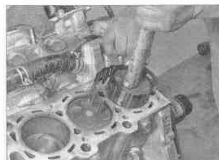
Рис. 21.11. Мягко постукивая ручкой молотка, вставьте поршень в цилиндр
