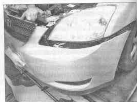
Рис. 6.7,в. ...и снимите бампер с автомобиля
