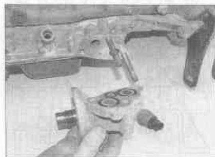
Рис. 13.8, а. Снимите корпус масляного фильтра...
