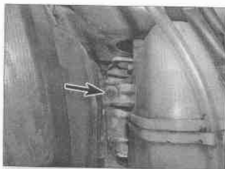
Рис. 13.3.б. ...и внутренний болт (отмечен стрелкой)
