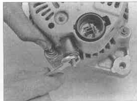
Рис. 7.2,б. Отверните гайку, снимите шайбу и изолятор с клеммы В и снимите заднюю крышку (генератор Denso)
