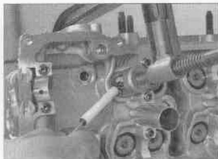
Рис. 7.3. Сожмите пружину настолько, чтобы с помощью маленькой магнитной отвертки или пассатижей с длинными губками можно было снять сухари со стержня клапана
