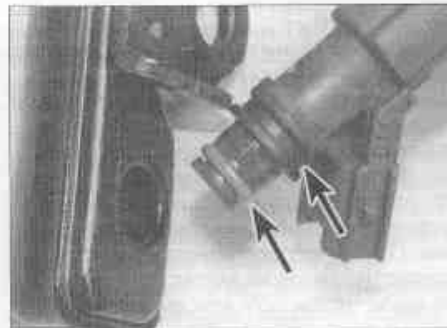
Рис. 12.28. Замените уплотнительные кольца и уплотнительные втулки форсунок (отмечены стрелками)
