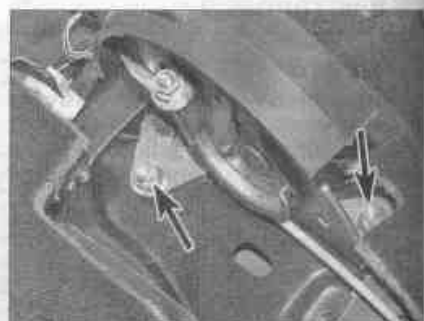
Рис. 16.4. Болты крепления рычага стояночного тормоза (отмечены стрелками)
