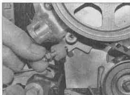
Рис. 7.14. Снятие дистанционного элемента/направляющей ремня из-под зубчатого шкива распределительного вала
