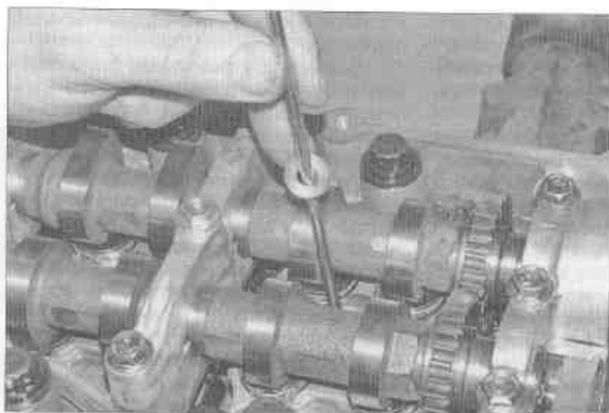
Рис. 11.19. Используя узкую отвертку, направьте новые седла форсунок в головку цилиндров
