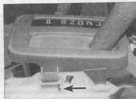
Рис. 4.4,а. Отпустите зажимы панели рычага селектора (один из них отмечен стрелкой)
