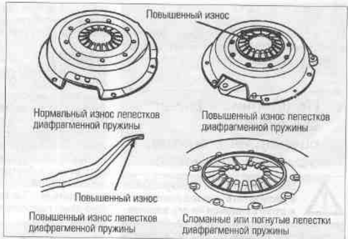
Рис. 3.11,а. При наличии любого из этих состояний замените кожух сцепления
