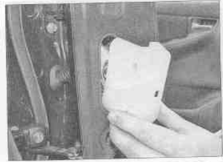
Рис. 12.2,б. ...снимите пластмассовую панель отделки...
