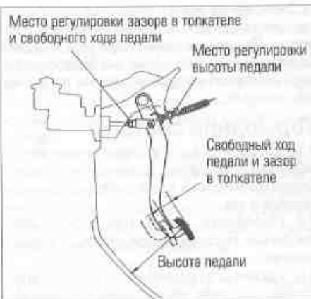
Рис. 14.5,а. Регулировки зазора в толкателе, высоты и свободного хода педали выполняются путем отпущивания контргайки и вращения резьбового регулятора
