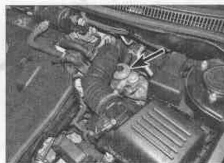
5 Убедитесь в надежности крепления топливного фильтра и топливопроводов и в отсутствии воздуха в системе (показана модель с дизельным двигателем)
