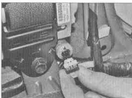
Рис. 26.5,б. ...и разъедините электрический разъем
