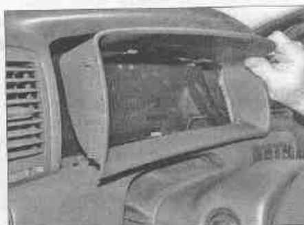
Рис. 5.3,б. ...и излеките обрамление щитка приборов
