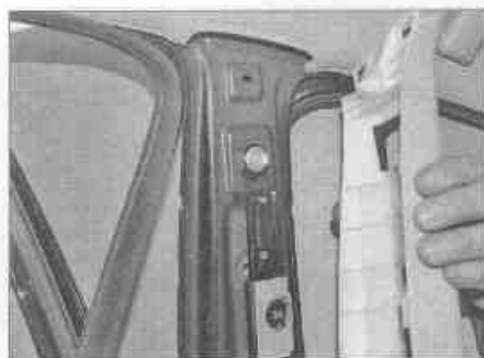
Рис. 26.4,б. ...и высвободите верхнюю панель отделки стойки
