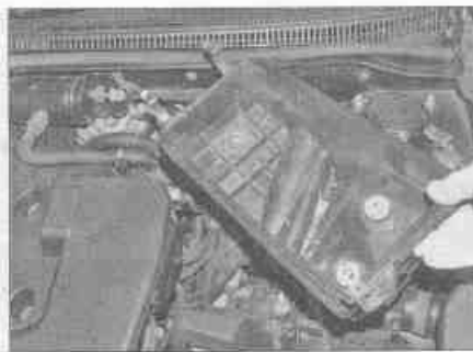
Рис. 6.5,б. ... и снимите корпус воздушного фильтра, отделяя его от воздушного впускного коленчатого патрубка
