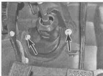
Рис. 18.4. Отверните гайки и снимите крышку
