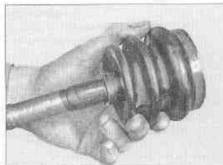
Рис. 3.12,а. Во избежание повреждения чехлов обмотайте шлицы полуоси липкой лентой
