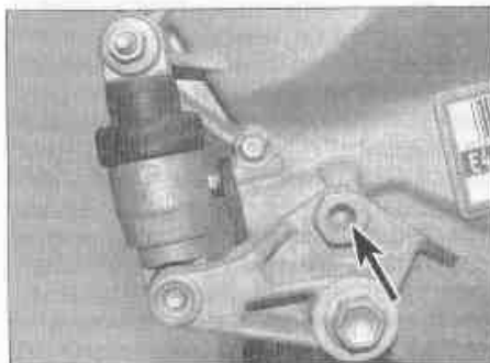
Рис. 8.3. Поверните натяжитель гаечным ключом за шестигранную секцию (отмечена стрелкой)
