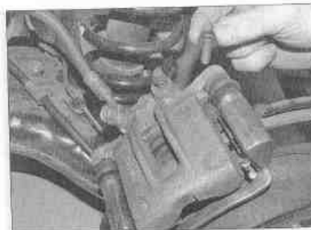
Рис. 5.2,а. Выверните болты крепления направляющих пальцев суппорта...
