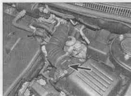
Рис. 13.11. Расположение датчика расхода воздуха
