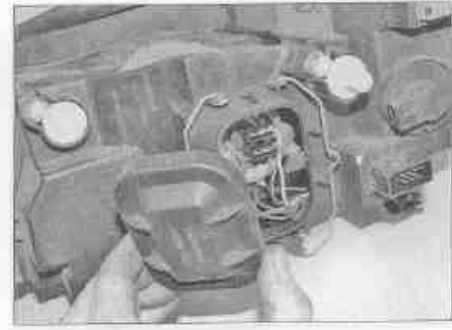
Рис. 7.2,б. ...и снимите пластмассовую крышку
