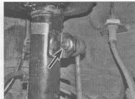
Рис. 11.3,а. Отверните верхнюю гайку (отмечена стрелкой)...
