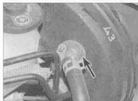
Рис. 14.2. Обратный клапан вакуумного усилителя тормозов (отмечен стрелкой)
