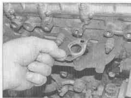
Рис. 6.2,б. ...и снимите прокладки с выпускного коллектора...
