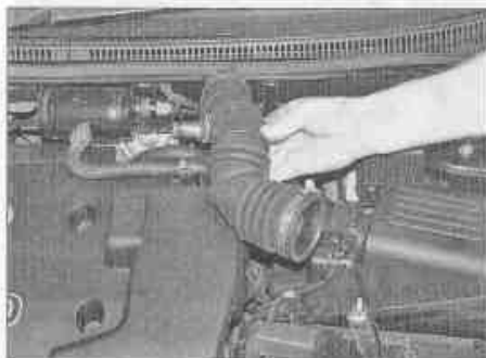
Рис. 6.1. Снимите впускной воздушный шланг
