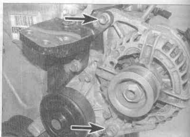
Рис. 6.5. Болты крепления генератора (отмечены стрелками) (показана модель с бензиновым двигателем)
