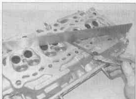
Рис. 8.12. Проверьте сопрягаемую поверхность головки цилиндров на неплоскостность, используя щуп и линейку
