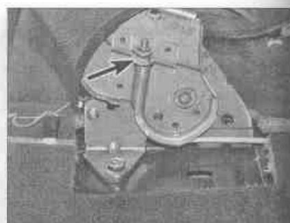
Рис. 15.6. Нижняя регулировочная гайка (отмечена стрелкой)
