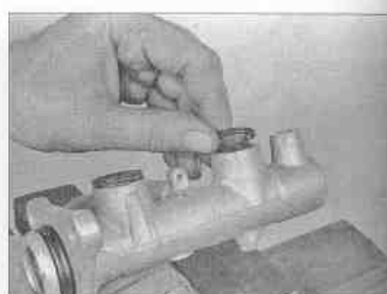
Рис. 11.6,б. Извлеките уплотнительные втулки из главного цилиндра
