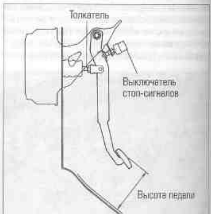
Рис. 12.7,б. Высота педали тормоза — это расстояние между педалью и металлическим полом при опущенной педали
