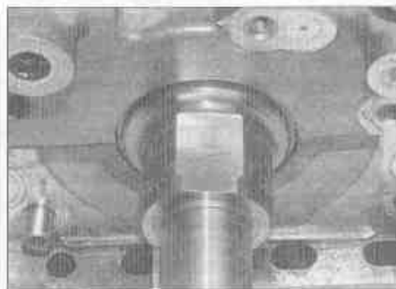
Рис. 11.11. Совместите лыски на коленчатом вале с лысками на роторе насоса
