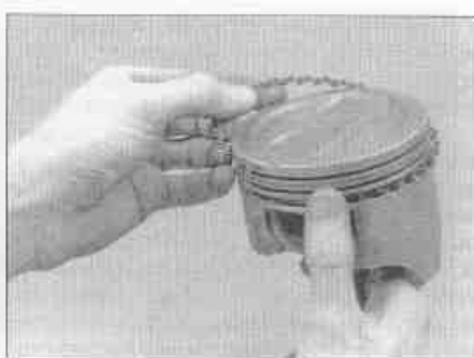
Рис. 19.9,а. Установите расширительное кольцо в канавку для маслосъемного кольца
