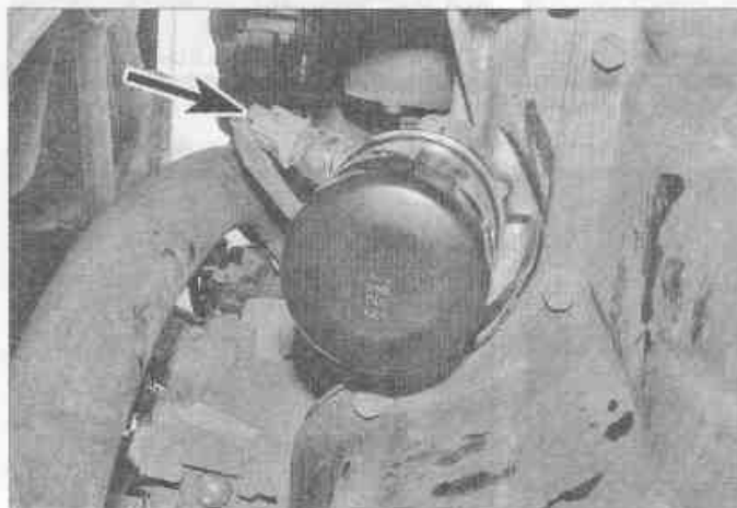
Рис. 12.2. Датчик давления масла находится над масляным фильтром
