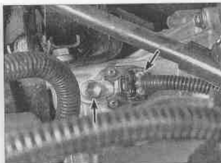
Рис. 3.9. Рассоедините электрический разъем датчика скорости (отмечен стрелкой), выверните болт (отмечен стрелкой) и снимите датчик скорости
