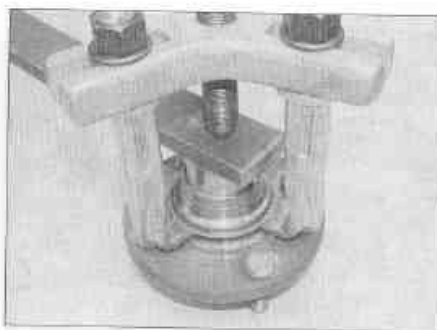
Рис. 8.3. Если внутреннее кольцо подшипника остается на ступице, снимите его, используя съемник или зубило
