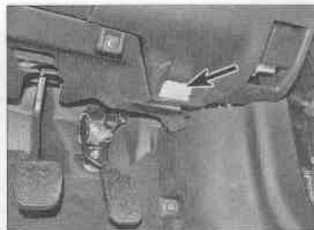
Рис. 11.10. Диагностический разъем внутри автомобиля
