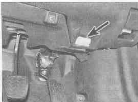
Рис. 12.3. Диагностический разъем внутри автомобиля
