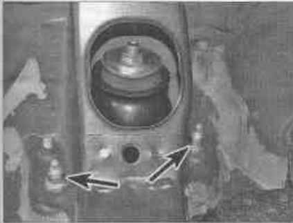
Рис. 10.5. Отверните две верхних гайки (отмечены стрелками)
