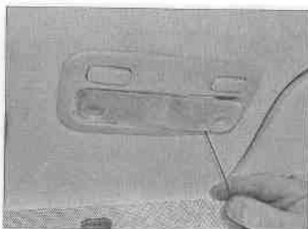
Рис. 8.3.а. Высвободите рассеиватель переднего плафона освещения салона
