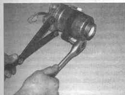
Рис. 17.6,а. Используя ленточный ключ для снятия масляного фильтра, отверните фильтрующий элемент...
