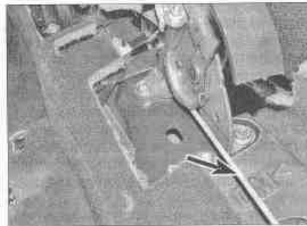
Рис. 17.10. Передний трос стояночного тормоза (отмечен стрелкой)
