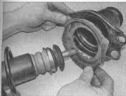
Рис. 3.11. Снимите верхнюю тарелку пружины и изолятор
