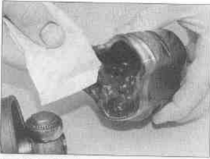
Рис. 3.12,в. Набейте смазкой корпус шарнира
