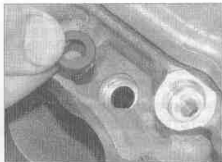
Рис. 12.27,б. ...и вытяните уплотнительные втулки из отверстий для форсунок
