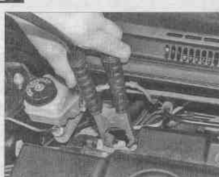
4 Подсоедините другой конец черного провода к какому-нибудь болту или кронштейну на блоке цилиндров запускаемого двигателя, подальше от аккумулятора
