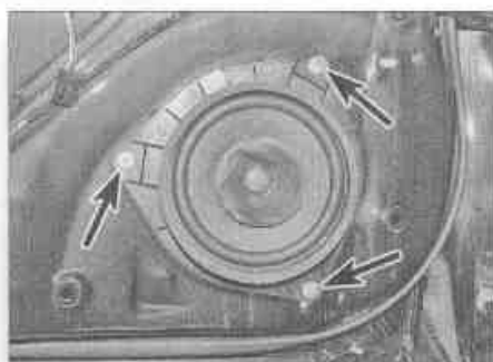
Рис. 18.3. Заклепки (отмечены стрелками) крепления динамика к панели двери
