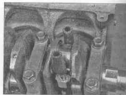
Рис. 11.5. Перед извлечением поршней наденьте обрезки шланга на болты шатуна
