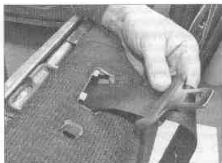
Рис. 26.23,б. ...и снимите обивку сиденья над ремнем безопасности
