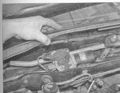
Рис. 15.4.6. ...и снимите панель отделки капота перед ветровым стеклом
