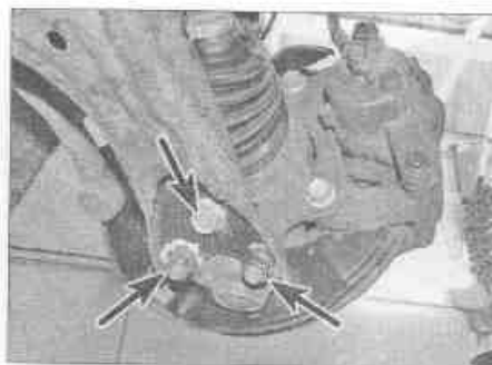
Рис. 5.2,а. Отверните гайки и выверните болт (отмечены стрелками)...
