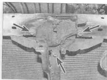
Рис. 8.10. Болты крепления защелки капота (отмечены стрелками)
