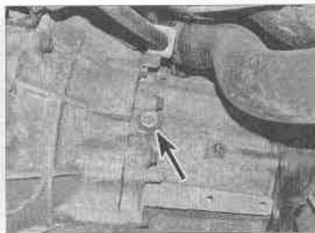
Рис. 7.2. Пробка контрольного отверстия механической коробки передач (отмечена стрелкой)
