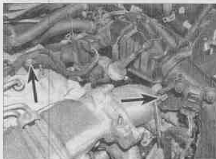
Рис. 13.3. Выверните болты крепления впускного воздухопровода (отмечены стрелками)
