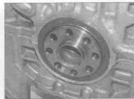
Рис. 14.3,б. ...так, чтобы внешняя кромка манжеты была расположена запядице с блоком цилиндров
