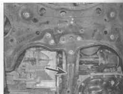
Рис. 18.9. Снимите центральную стяжку (отмечена стрелкой)
