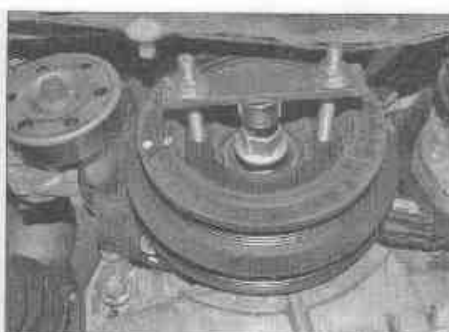
Рис. 7.6,б. ...затем, используя съемник, стяните шкив с конца коленчатого вала...
