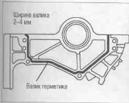
Рис. 11.51. Нанесите герметик на корпус манжеты распределителя, как показано
