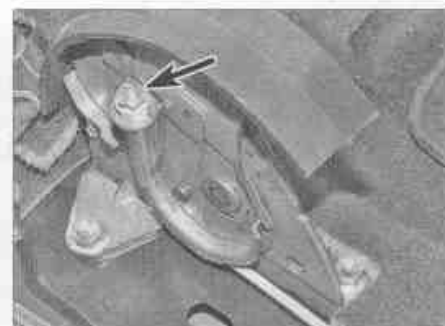
Рис. 15.2. Отпустите верхнюю контргайку (отмечена стрелкой)
