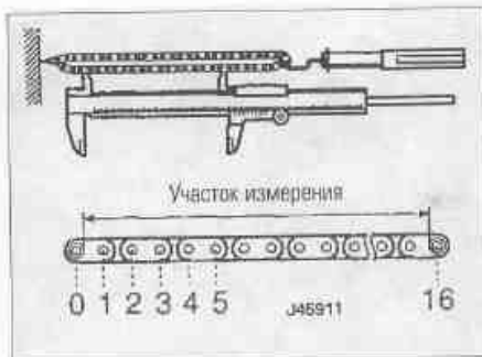
Рис. 5.21. Туго натяните цепь и измерьте длину участка между шестнадцатью валиками, как показано
