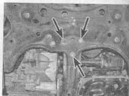
Рис. 7.13,б. ...и задние болты (отмечены стрелками)
