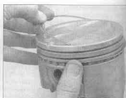
Рис. 19.9,б. Не используйте инструмент для установки поршневых колец при установке элементов маслосъемного кольца
