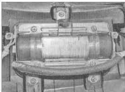
Рис. 20.17. Гайки/болты крепления подушки безопасности пассажира
