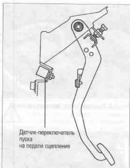
Рис. 7.4. Датчик-переключатель педали сцепления расположен под лицевой панелью на кронштейне перед педалью сцепления
