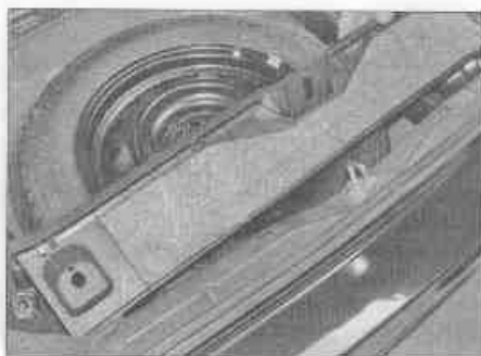
Рис. 17.16. Снимите заднюю панель отделки
