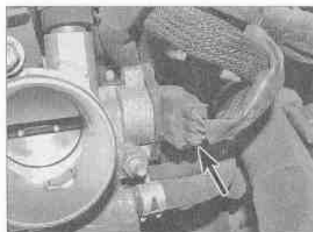
Рис. 12.4. Электрический разъем датчика положения дроссельной заслонки (TPS)
