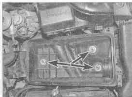
Рис. 6.5,а. Выверните болты (отмечены стрелками)...
