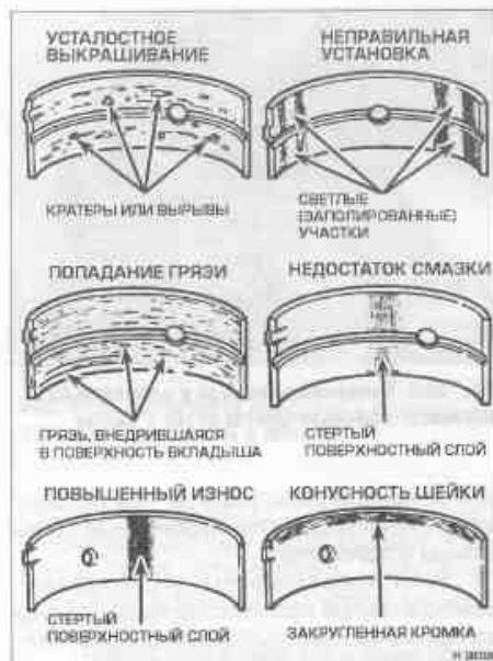
Рис. 17.1. Типичные повреждения вкладышей
