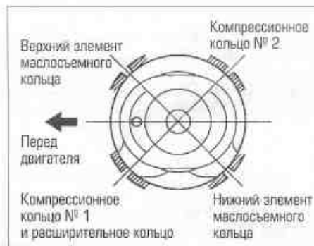
Рис. 21.5,а. Расположение замков поршневых колец на бензиновых двигателях
