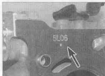
Рис. 9.18. Номер партии должен быть обращен вверх (отмечен стрелкой)
