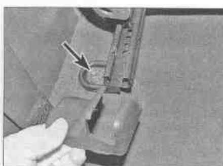
Рис. 24.1,б. ...и выверните задние болты крепления салазок переднего сиденья (отмечены стрелками)
