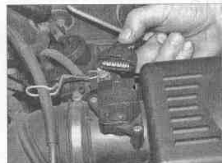
Рис. 8.1. Рассоедините электрический разъем
