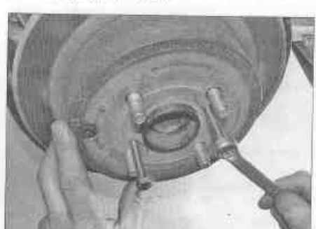
Рис. 7.5. Используя два болта, отожмите диск от ступицы
