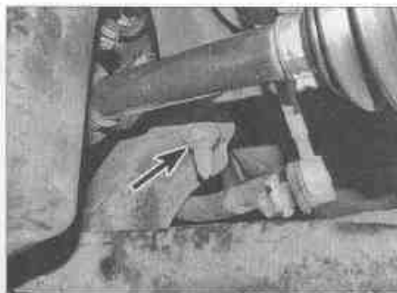
Рис. 18.12. Передние гайки крепления поперечины (показана одна сторона)
