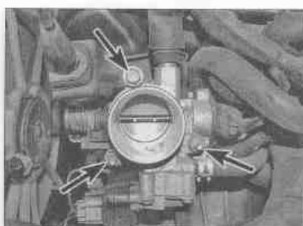
Рис. 12.9. Гайки крепления корпуса дроссельной заслонки (отмечены стрелками)
