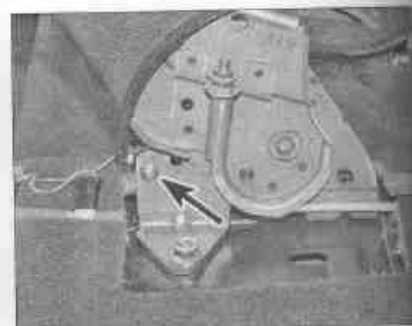
Рис. 4.28. Винт крепления выключателя контрольной лампы стояночного тормоза (отмечен стрелкой)
