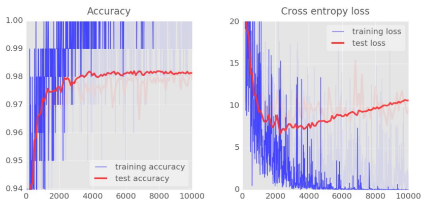
图 3-20 应用 Adam 优化算法后，精度和损失趋于稳定
